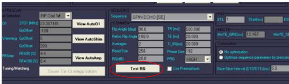
出现结果后, 进入底层软件, 点击 1D FFT, 进行一维傅里叶变换, 结果图像中心在 0KHZ 时, 表示此时样品频率方向对应的位置在中心。反之可以微调后重复测试, 直至样品在中心。
